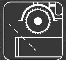
Произвести запил с обеих сторон молдинга (обновить заводской рез) при помощи торцовочной пилы быстрым, рубящим движением. Пильный диск должен иметь максимальное количество зубьев (диск по алюминию).
