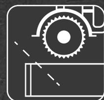
Произвести запил с обеих сторон молдинга (обновить заводской рез) при помощи торцовочной пилы быстрым, рубящим движением. Пильный диск должен иметь максимальное количество зубьев (диск по алюминию).
